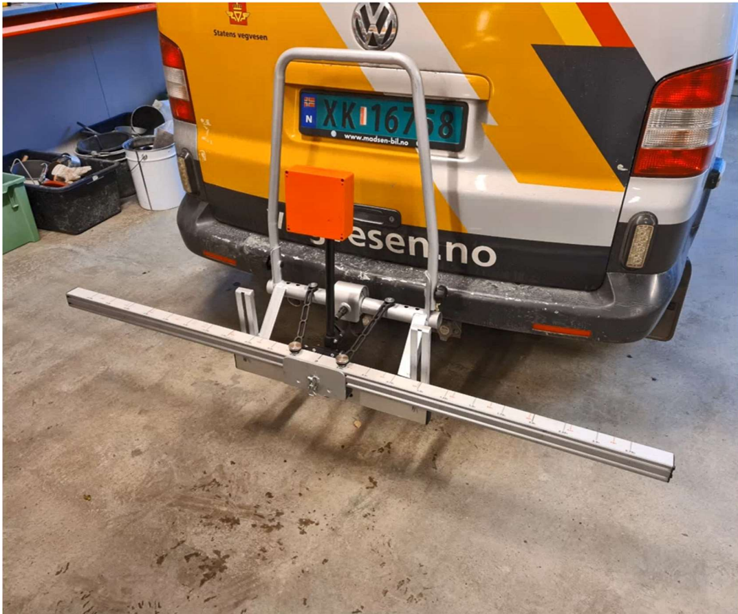
Figur 3 SVVs specialkonstruerade armatur för montering av antenner på bil
